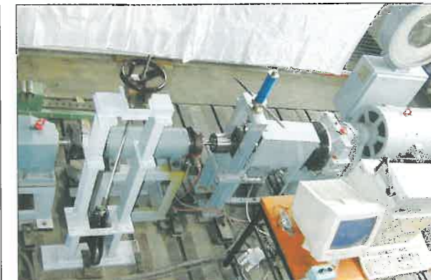
Bild 4 Prüfstand für die Untersuchung von Pressverbindungen bei Torsion und Umlaufbiegung
