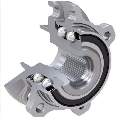
Abbildung 2: Leistungssteigerung beim Radlager. Vom ungeschmierten Gleitlager zum lebensdauer-geschmierten zweireihigen Schrägkugellager in O-Anordnung mit formschlüssiger Anbindung an die Gelenkwelle. (Copyright links: public domain, rechts: [2])
