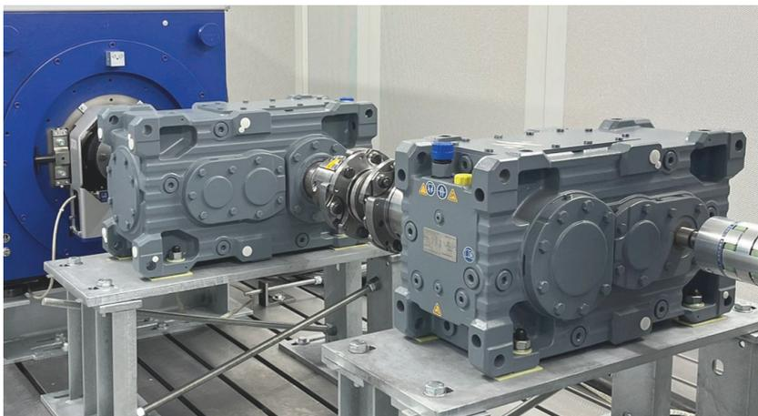
Abbildung 3: Back-to-Back Anordnung der Prüfgetriebe innerhalb des exemplarischen Prüfaufbaus
