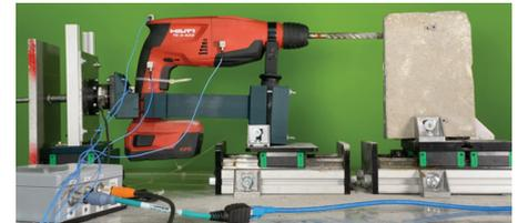
Abbildung 2: Komponententest zum Nachweis der Erfüllung von Anforderungen am Beispiel Schlagbohrmaschine
