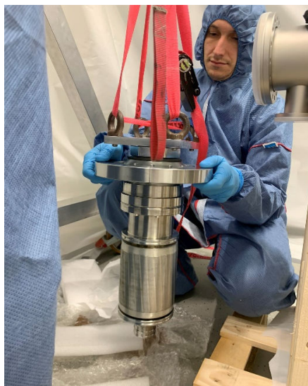
Abbildung 7: Anode und Rotorkörper werden mit dem Motor in einem Reinraum zusammengebaut
