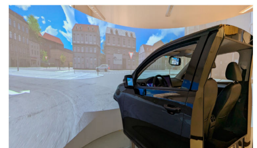
Bild 1 Fahrsimulatorenaufbau am Institut für Arbeitswissenschaft und Organisation (IFAB) des KIT
