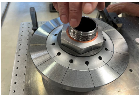
Abbildung 5: Die Anode mit der glänzenden Wolframspur auf der Oberseite und dem Körper aus TZM-Legierung wird auf den Rotor montiert
