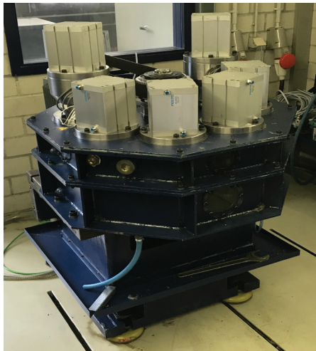
Bild 1: Reibprüfstand rotatorisch mit der Möglichkeit zur simultanen Untersuchung des Reibungs- und Verschleißverhaltens von 6 Prüflingen (hier Wälzlager).
